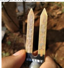
Gambar 11. Sisi Probe Luntur
