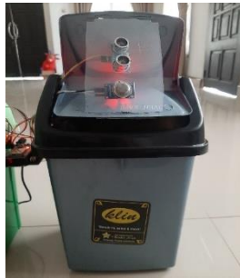
Gambar 6 Pemasangan tempat sampah 1 Rangkaian alat yang telah dibuat dipasang pada tutup tempat sampah untuk memantau kondisi yang ada di dalam tempat sampah. Sensor ultrasonik dan sensor gas menghadap langsung pada sampah.
