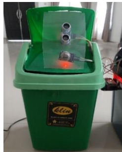
Gambar 7 Pemasangan alat tempat sampah 2 Pemasangan alat pada tempat sampah 2 dilakukan dengan cara yang sama seperti pada tempat sampah 1. Penggunaan dua tempat sampah bertujuan untuk mengetahui efektifitas penggunaan alat IoT.
