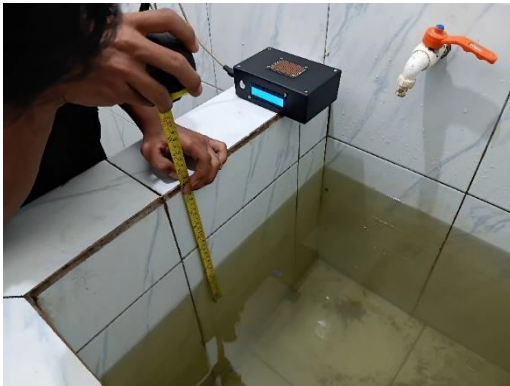
Gambar 9 pengujian kedua dengan jarak 20cm
