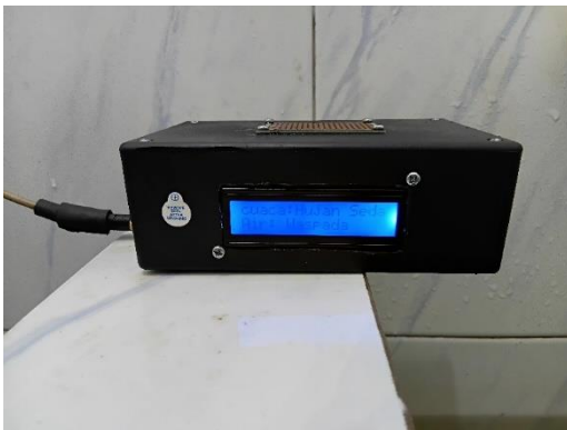
Gambar 10 ditampilkan layar LCD dan pengujian 2 semprotan untuk sensor hujan
