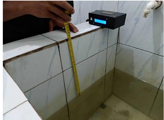
Gambar 6 Pengujian Pertama dengan jarak 30cm
