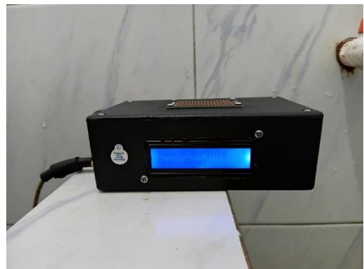
Gambar 7 ditampilkan layar LCD dan pengujian 1 semprotan untuk sensor hujan
