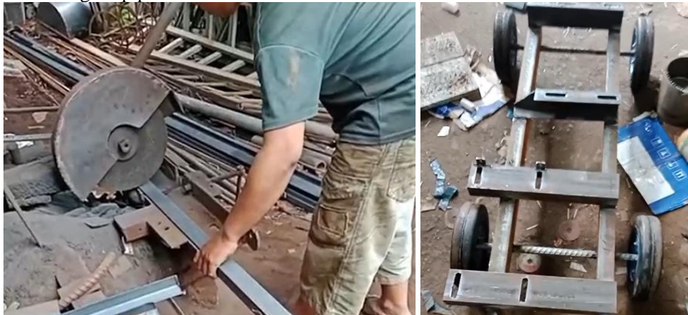
Gambar 6. Proses pembuatan kaki-kaki bagi mesin irigasi di perbengkelan
