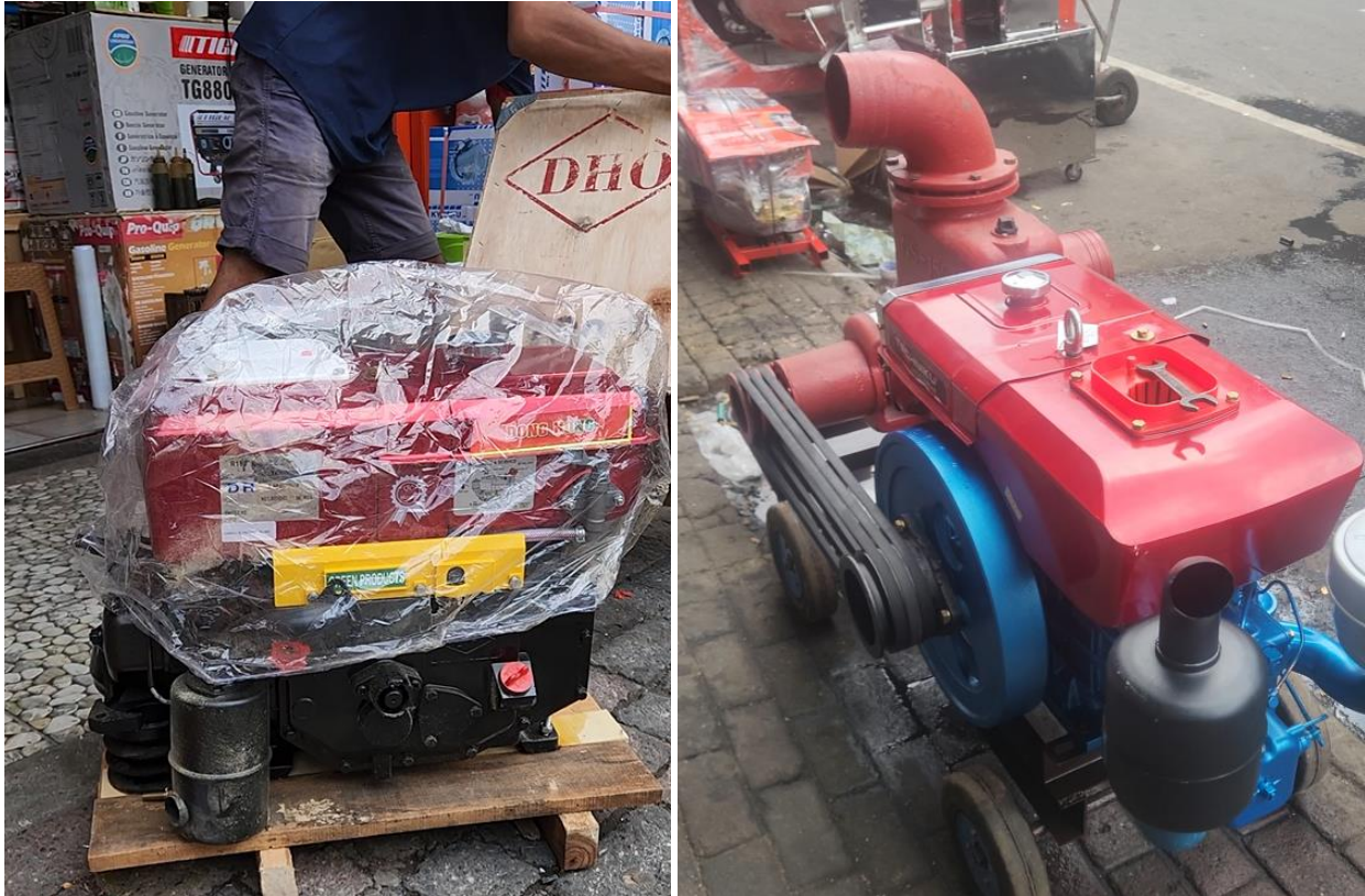
Gambar 7. Alat alcon sedot air 6 inchi yang telah dipasangkan ke mesin diesel 27 HP
