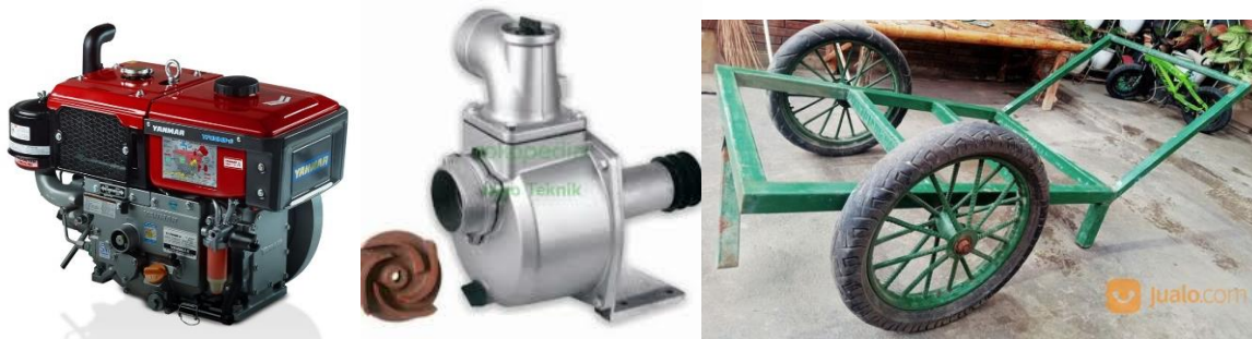
Gambar 4. Ilustrasi mesin mesin penggerak utama berkekuatan 15 HP (kiri); alat alkon sedot air (Tengah); kerangka roda besi untuk memudahkan mobilitas mesin sedot air (kanan)
